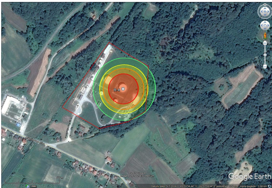
Slika 36. Zone ugroženosti uslijed istjecanja nafte iz spremnika R-4 u tankvanu i nastanka požara
