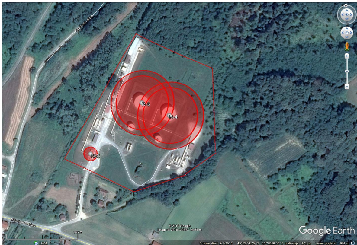
Slika 8. Prikaz granica dominoefekta ( 12,5 \text{ kW/m}^2 ) za spremnike R-3, R-4 i pretakalište autocisterni na području postrojenja Otpremne stanice Šandrovac
