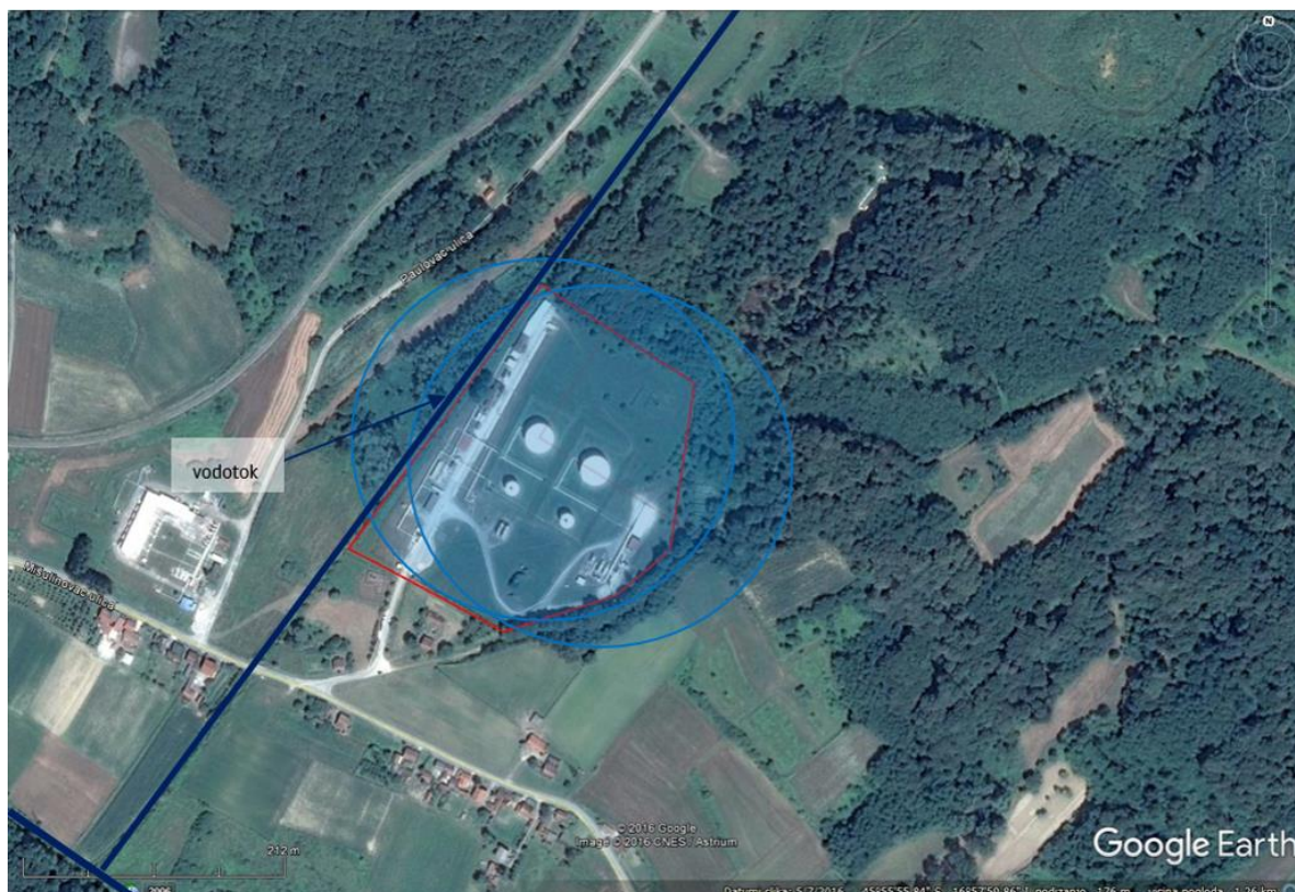
Slika 34. Zone ugroženosti uslijed istjecanja nafte iz spremnika R3 ili R4 (izlivanje nafte na površinu)
