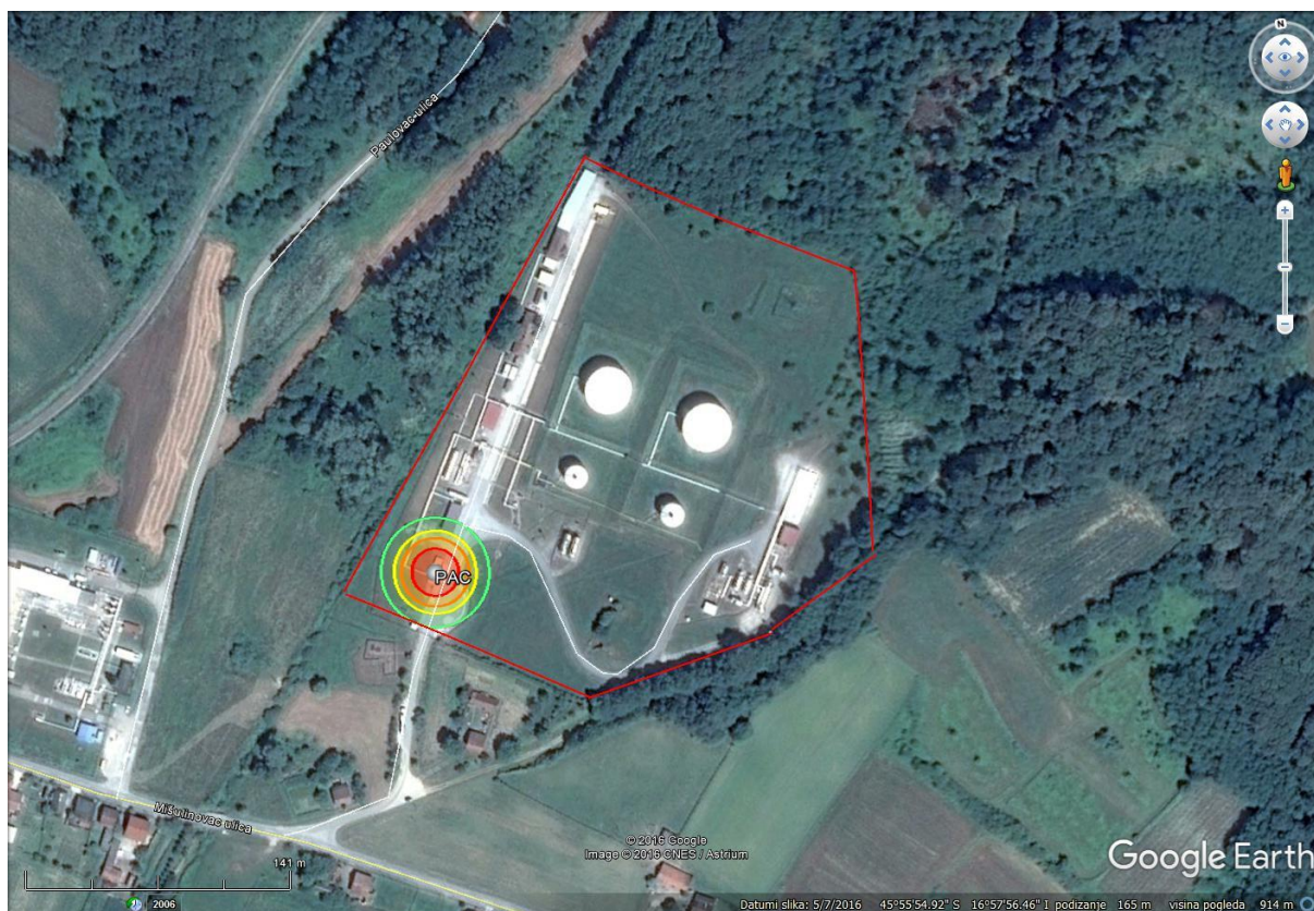
Slika 39. Zone ugroženosti uslijed istjecanja i zapaljenja nafte iz autocisterne
